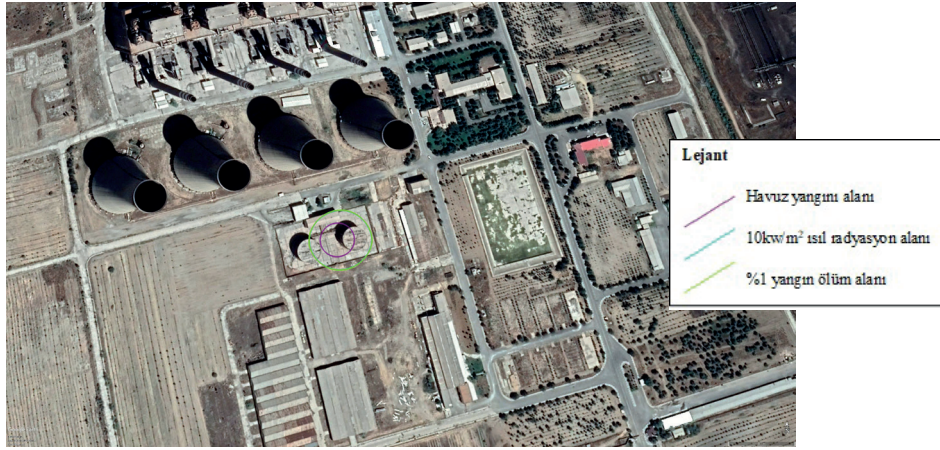
Şekil 2. 34. | Çelikler Afşin Elbistan Elektrik Üretim ve Ticaret A.Ş. A Termik Santraline ait Tehlike Analizi
