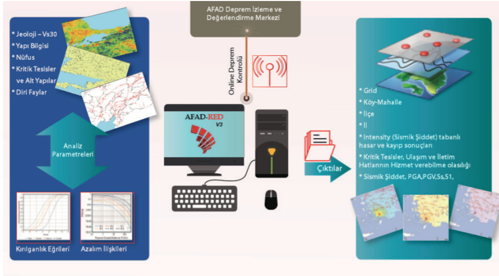
Şekil 2. 3. | AFAD-RED Çalışma Prensibi
